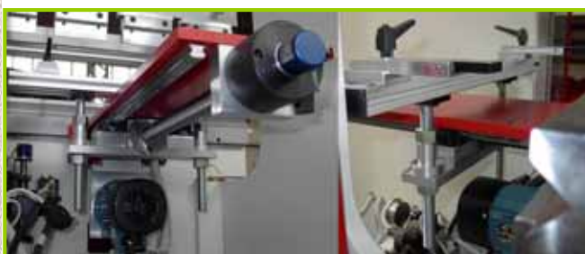
R egistro posteriore motorizzato C.C. con vite a ricircolo di sfere gestito da preselettore o CNC B ack motorized rear register with ball screw adjusted by a dimensional preselector or CNC
